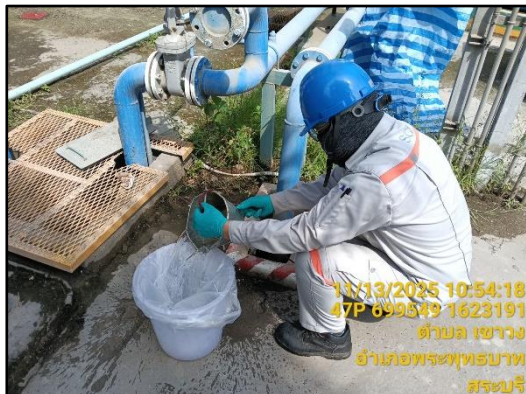
ภาพที่ 3.24 การตรวจวัดคุณภาพน้ำ บริเวณ Regenerate resin ที่ระบายลงสู่บ่อเก็บน้ำทิ้งรวม
