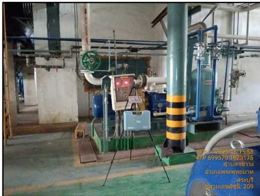
ภาพที่ 3.33 การตรวจวัดระดับเสียงบริเวณเครื่องจักร บริเวณปั๊ม (WHG)
