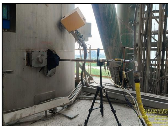
ภาพที่ 3.6 การตรวจวัด HCl จากปล่องหม้อเผา
