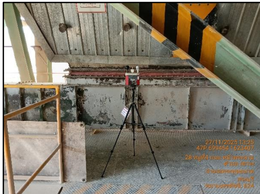
ภาพที่ 3.44 การตรวจวัดความร้อนในสถานที่ทำงานบริเวณ PH Boiler ชั้น 1
